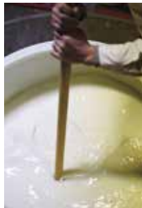
酒母に米と麹を加えていく、漆掛仕込み作業。
